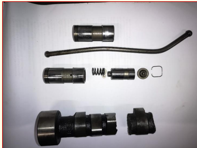
De stoter die de tuimelaar bediend is verbogen. De nokkenas is gebroken.
