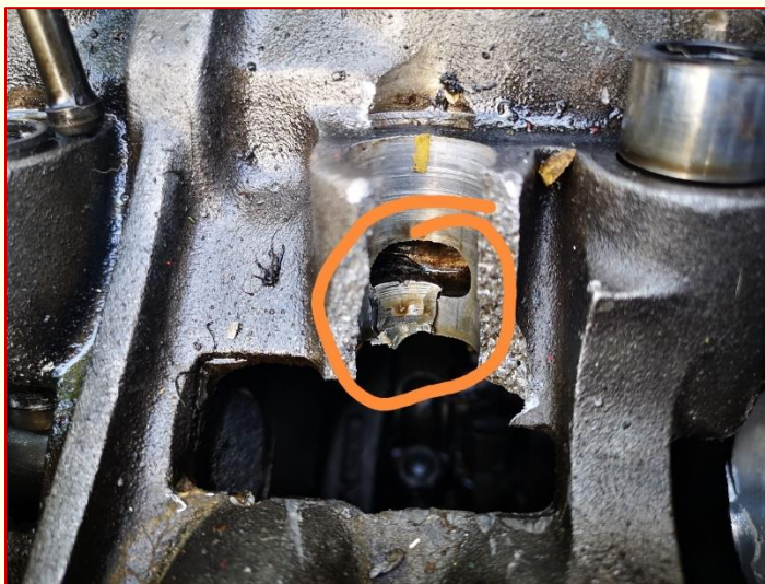
Duidelijk dat de plunjer is vastgelopen in de behuizing.
